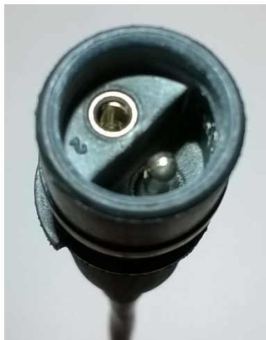
Afbeelding 3 - Aansluitstekker van de temperatuursonde
